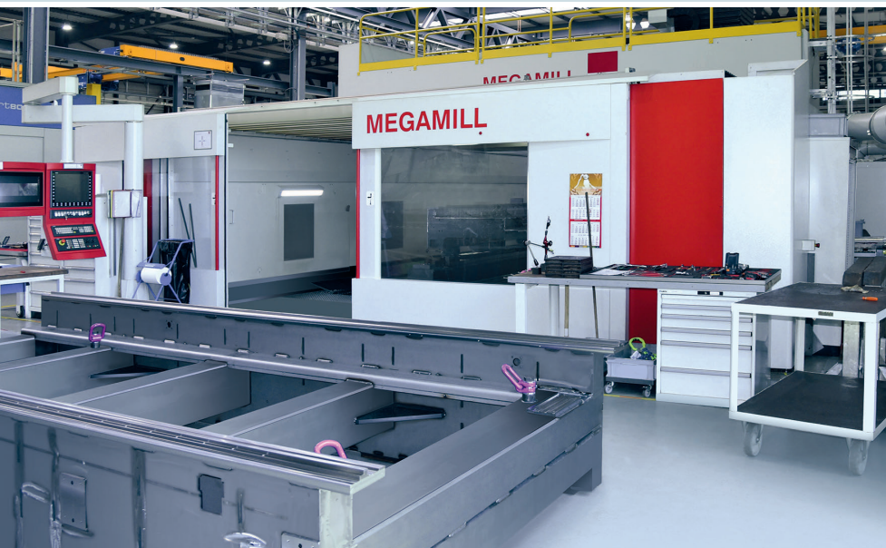
2 Das Hoch-Portalfräszentrum Megamill von Emco Mecof, eingebunden in den Fertigungsprozess bei der Bystronic Laser AG © Emco
